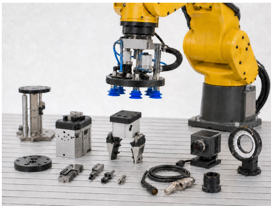
Herramientas de vacío, pinzas, adaptadores y accesorios de visión e iluminación.
