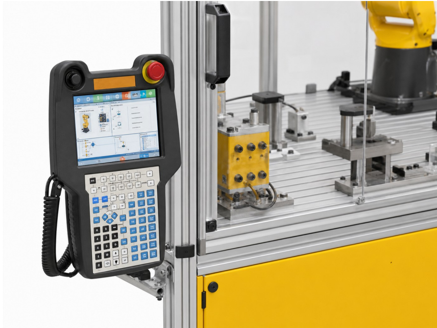
Terminal táctil, parada de emergencia y área didáctica de trabajo.
