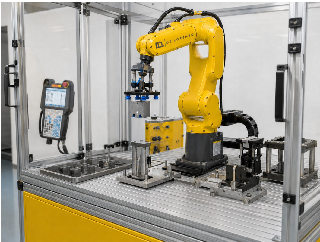
Práctica de selección y colocación con herramienta de vacío.
