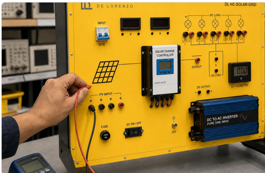
Práctica de conexión con cables banana de seguridad de 4 mm.
