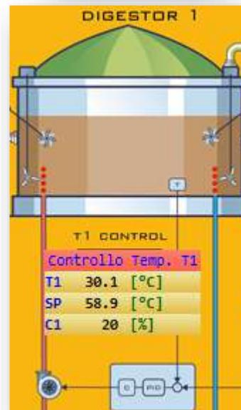
À cet effet, le simulateur contient un régulateur PID pour le contrôle de la température.
