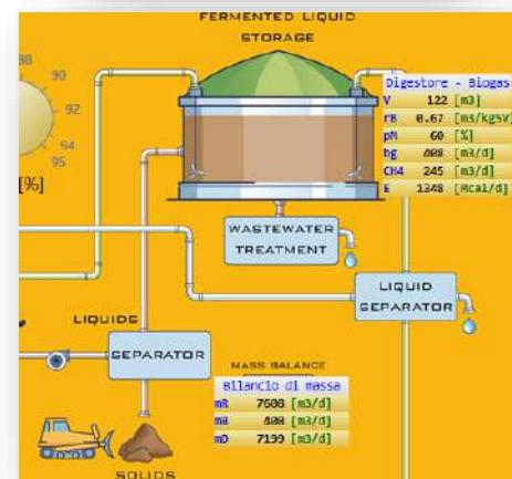
Toutes les variables de fonctionnement du réacteur sont affichées sur des mini-interfaces appropriées avec les données de bilan massique.
