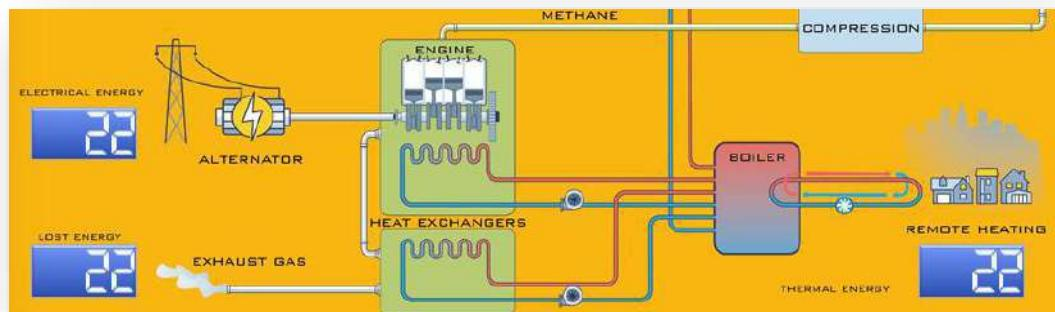
Des affichages spéciaux montrent: l'énergie électrique produite, l'énergie thermique produite et l'énergie perdue.
