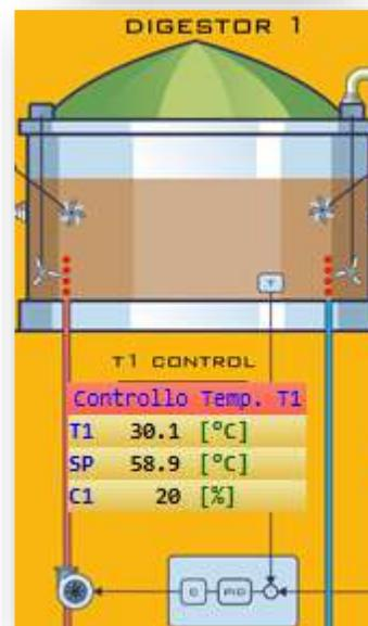
A tale proposito il simulatore contiene un regolatore PID per il controllo della temperatura.
