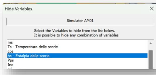
Il valore della variabile non appare più allo Studente sul Simulatore. Egli ne deve calcolare il valore utilizzando bilanci di massa, di energia, o altro a seconda del tipo di variabile.
