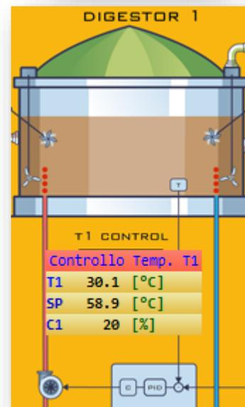
Pour un fonctionnement optimal du système, la température dans les digesteurs doit être régulée à des valeurs optimales et maintenue constante.
