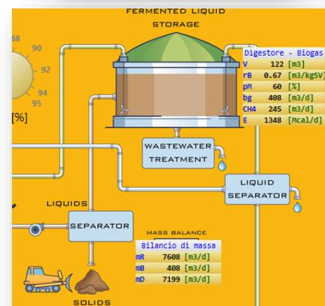
Toutes les variables de fonctionnement du réacteur sont affichées sur des mini-consoles appropriées avec les données de bilan massique.
