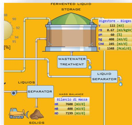
Todas las variables de funcionamiento del reactor se muestran en miniconsolas apropiadas junto con los datos del balance de masa.
