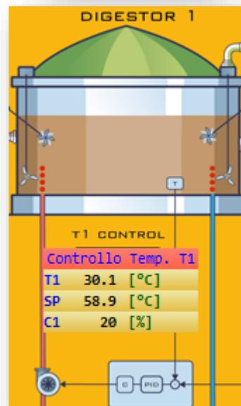
Para este propósito, el simulador contiene un controlador PID para el control de la temperatura.
