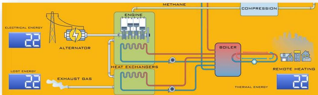
Pantallas especiales muestran: la energía eléctrica producida, la energía térmica producida y la energía perdida.
