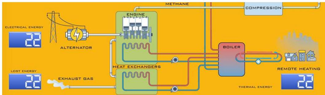
Su appositi display sono visualizzate: l'energia elettrica prodotta, l'energia termica prodotta, l'energia persa.
