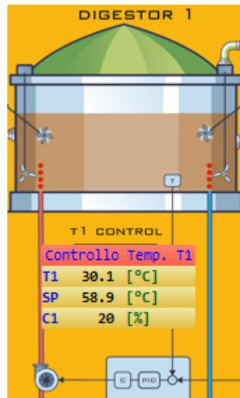
A tale proposito il simulatore contiene un regolatore PID per il controllo della temperatura.
