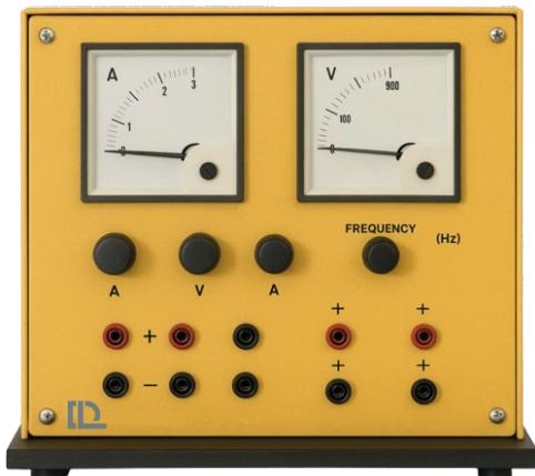
La incorporación de módulos de reactivos (C, L, R) amplía aún más la gama de prácticas, permitiendo analizar fenómenos como el factor de potencia y la influencia de diferentes cargas sobre el sistema eléctrico.
