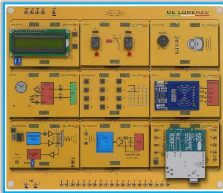
Esta placa permite estudiar las propiedades de un sistema RFID y todos los componentes necesarios para desarrollar un sistema de control de acceso. Los estudiantes pueden interactuar con el hardware de forma sencilla mediante un software que explica paso a paso el funcionamiento del sistema. La integración de los elementos RFID en un proceso industrial es posible mediante un software SCADA para el estudio de conceptos de automatización e Industria 4.0.
