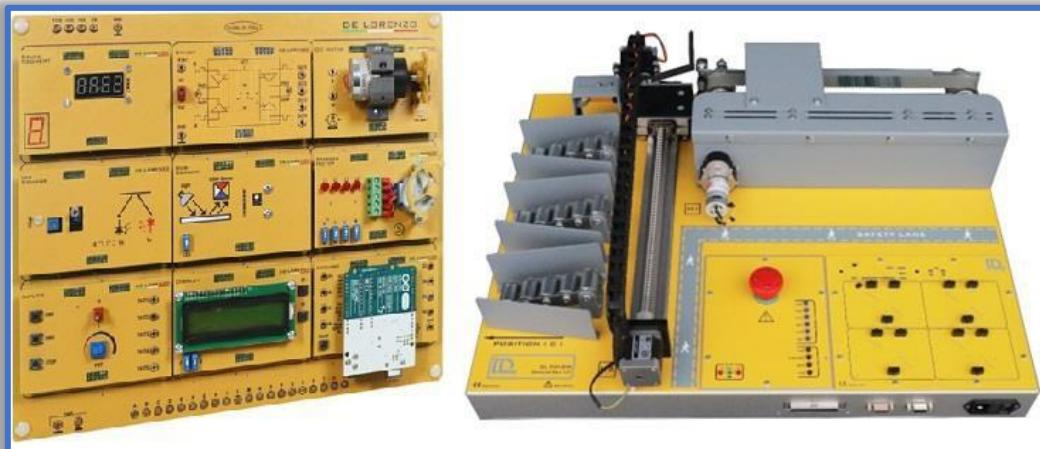
Compuesto por un simulador y placas electrónicas para el estudio de las propiedades y el funcionamiento de una cinta transportadora utilizada en entornos industriales. Incluye sensores y actuadores para desarrollar un curso completo sobre las principales características de los sistemas transportadores y sus aplicaciones.
