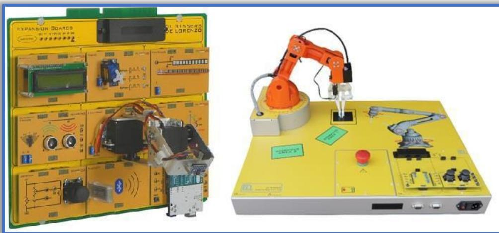
Compuesto por un simulador y placas electrónicas para el estudio de las propiedades y técnicas de control de un brazo robótico de 5 ejes utilizado en entornos industriales. Incluye sensores y actuadores para desarrollar un curso completo sobre sistemas de control de robots. Los estudiantes pueden interactuar con el hardware de forma sencilla mediante un software que explica paso a paso el funcionamiento del sistema.
