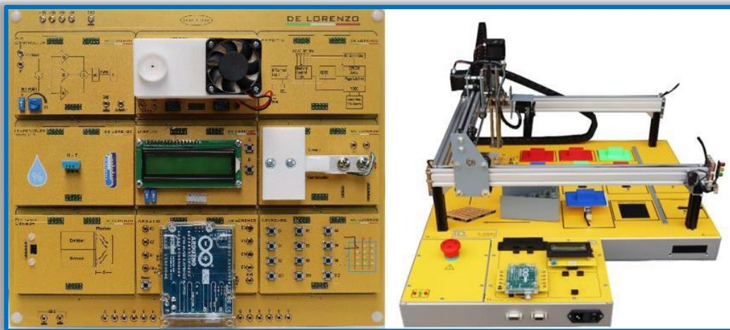
Compuesto por un simulador y placas electrónicas para el estudio de un almacén semiautomático en entornos industriales. Incluye sensores y actuadores para desarrollar un curso completo sobre las principales características de un almacén semiautomático y sus aplicaciones.
