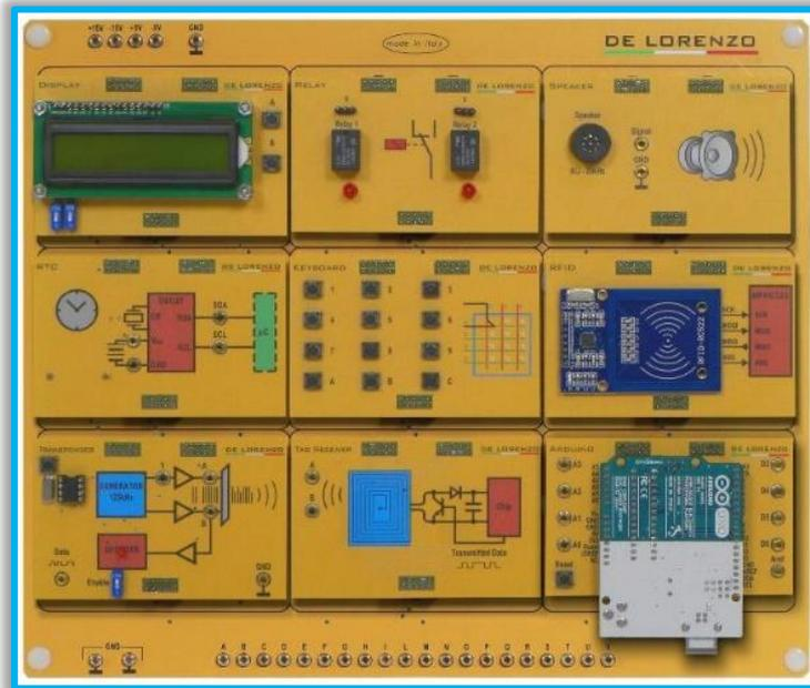
Questa scheda consente di studiare le proprietà di un sistema RFID e tutti i componenti necessari per sviluppare un sistema di controllo accessi alle porte. Gli studenti possono interagire con l'hardware in modo semplice tramite software che spiega passo dopo passo il funzionamento del sistema. L'integrazione degli elementi RFID in un processo industriale è possibile utilizzando un software SCADA per lo studio dei concetti di automazione e industria 4.0.
