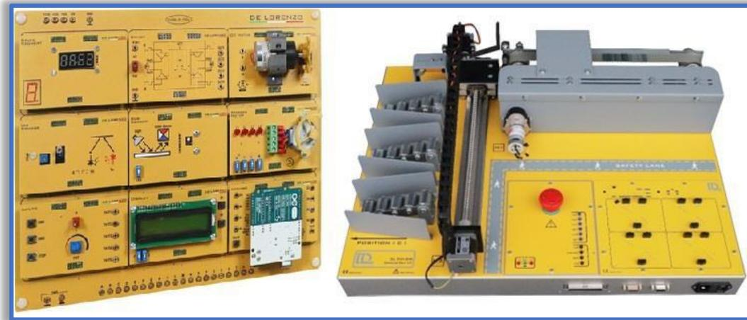
Composto da simulatore e schede elettroniche, per lo studio delle proprietà e del funzionamento di un nastro trasportatore utilizzato in ambienti industriali. Includono sensori e attuatori in modo da sviluppare un corso completo sulle caratteristiche principali dei sistemi di trasporto e delle loro applicazioni. Gli studenti possono interagire con l'hardware in modo semplice tramite software che spiega passo dopo passo il funzionamento del sistema.
