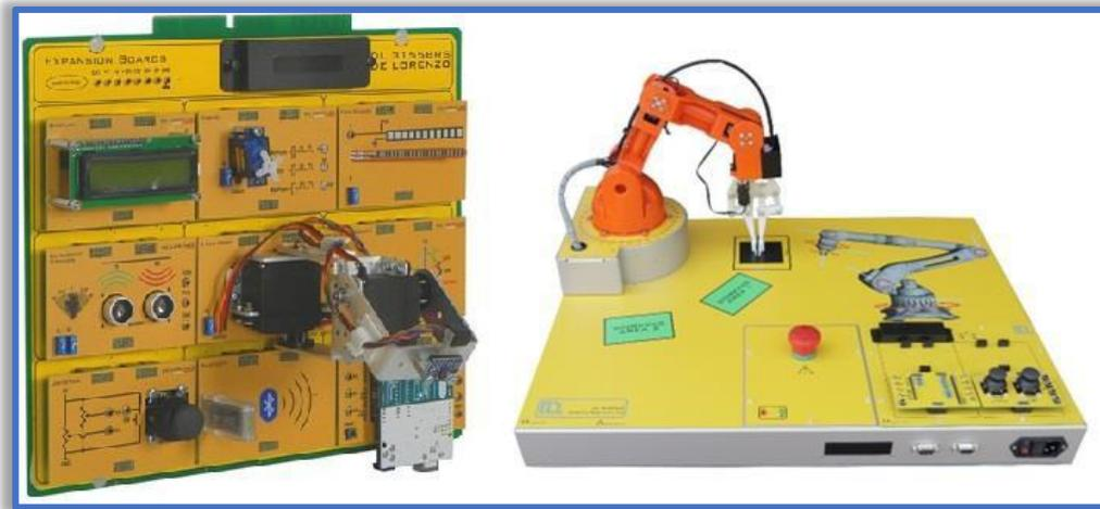
Composto da simulatore e schede elettroniche, per lo studio delle proprietà e delle tecniche di controllo di un braccio robotico a 5 assi utilizzato in ambienti industriali. Includono sensori e attuatori in modo da sviluppare un corso completo sui sistemi di controllo dei robot. Gli studenti possono interagire con l'hardware in modo semplice tramite software che spiega passo dopo passo il funzionamento del sistema.
