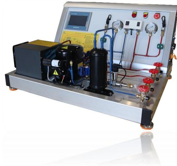
Ce système intelligent pour l'étude de la réfrigération et de la climatisation intègre les composants les plus avancés pour contrôler et optimiser les systèmes de manière efficace et durable. Il utilise des capteurs, des transducteurs, des appareils de mesure et des logiciels de gestion et de supervision pour surveiller et collecter des données en temps réel sur des paramètres critiques tels que la pression, l'humidité, le débit et la température.
