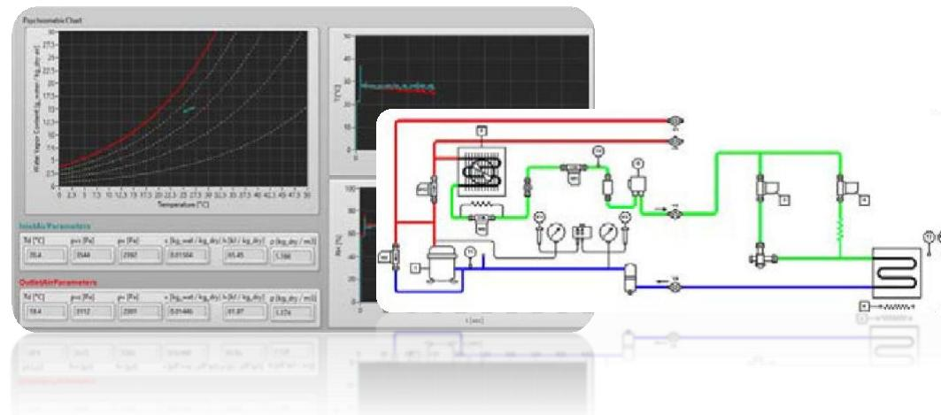
Il software di supervisione permette di controllare ingressi e uscite analogiche e digitali, lo stato delle elettrovalvole, del compressore, del ventilatore, del riscaldamento, del raffreddamento, dell'umidificazione e della deumidificazione, tra gli altri. È diverso per ogni modulo sperimentale e progettato per studiare e verificare le leggi della termodinamica e le loro applicazioni reali alla refrigerazione e al condizionamento dell'aria.
