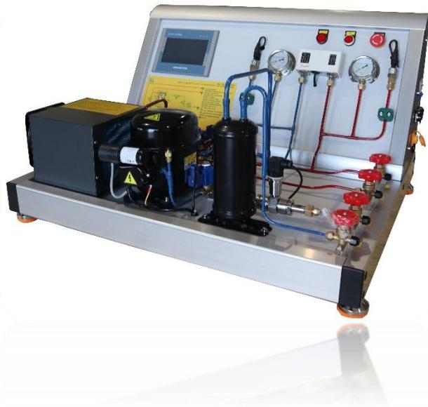
Questo sistema smart per lo studio della refrigerazione e della climatizzazione integra i componenti più avanzati per controllare e ottimizzare gli impianti in modo efficiente e sostenibile. Utilizza sensori, trasduttori, dispositivi di misurazione e software di gestione e supervisione per monitorare e raccogliere dati in tempo reale su parametri critici come pressione, umidità, flusso e temperatura.
