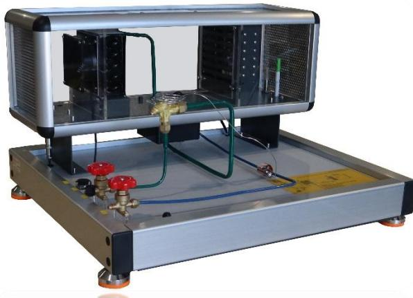
Questo trainer è stato progettato per lo studio completo ed esaustivo delle trasformazioni termodinamiche che l'aria subisce quando attraversa un'unità di condizionamento centrale a tre sezioni.
