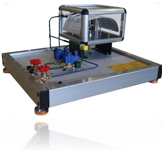
Questo trainer è stato progettato in modo che gli studenti possano acquisire i dati che caratterizzano il ciclo di refrigerazione e metterli in relazione con le caratteristiche termiche dei prodotti da conservare ad una temperatura di circa 0 °C.
