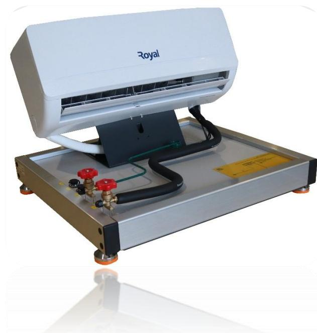
Questo trainer è stato progettato per sottolineare gli aspetti idraulici, meccanici e termodinamici dei condizionatori d'aria domestici di tipo split.
