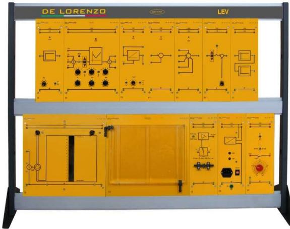
Ce laboratoire est conçu pour l'étude de l'application de contrôle de niveau afin de permettre à l'étudiant une formation pratique, basée sur la réalisation d'expériences guidées. Les composants de type industriel sont adaptés de manière pédagogique en utilisant un système de panneau modulaire afin de permettre l'assemblage pas à pas du circuit le plus simple au système le plus complexe.
