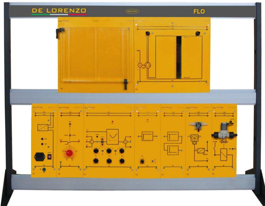
Ce laboratoire est conçu pour l'étude de l'application de contrôle du flux afin de permettre à l'étudiant une formation pratique, basée sur la réalisation d'expériences guidées. Les composants de type industriel sont adaptés de manière pédagogique en utilisant un système de panneau modulaire afin de permettre l'assemblage pas à pas du circuit le plus simple au système le plus complexe.
