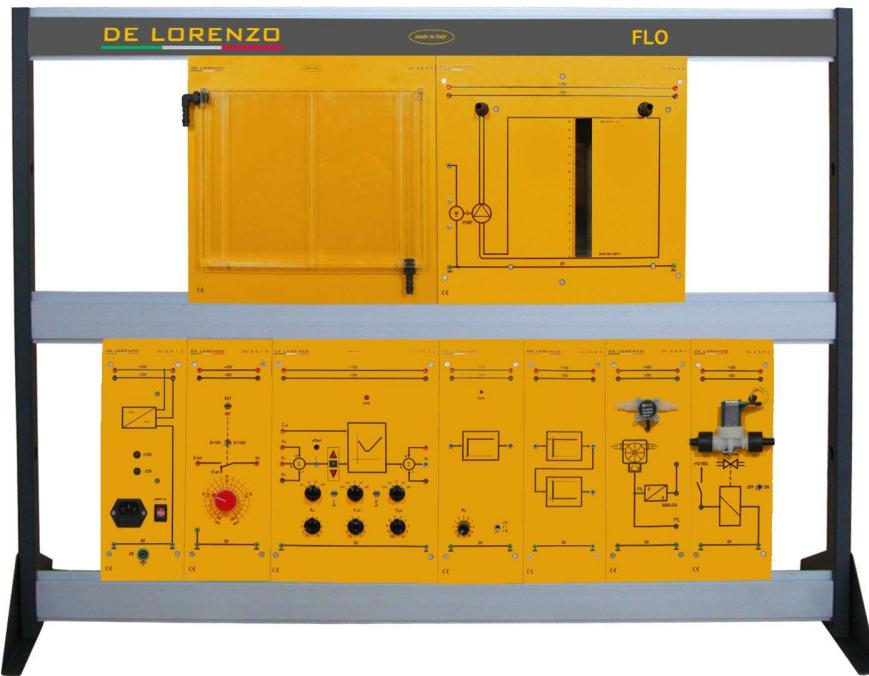
Este laboratorio está diseñado para el estudio de la aplicación de control de caudal para brindarle al alumno un entrenamiento práctico al realizar una serie de experimentos guiados. Los componentes de tipo industrial son adaptados para su uso didáctico en un sistema modular de paneles que permite hacer un montaje paso a paso que puede ir desde el circuito más simple hasta el sistema más complejo.
