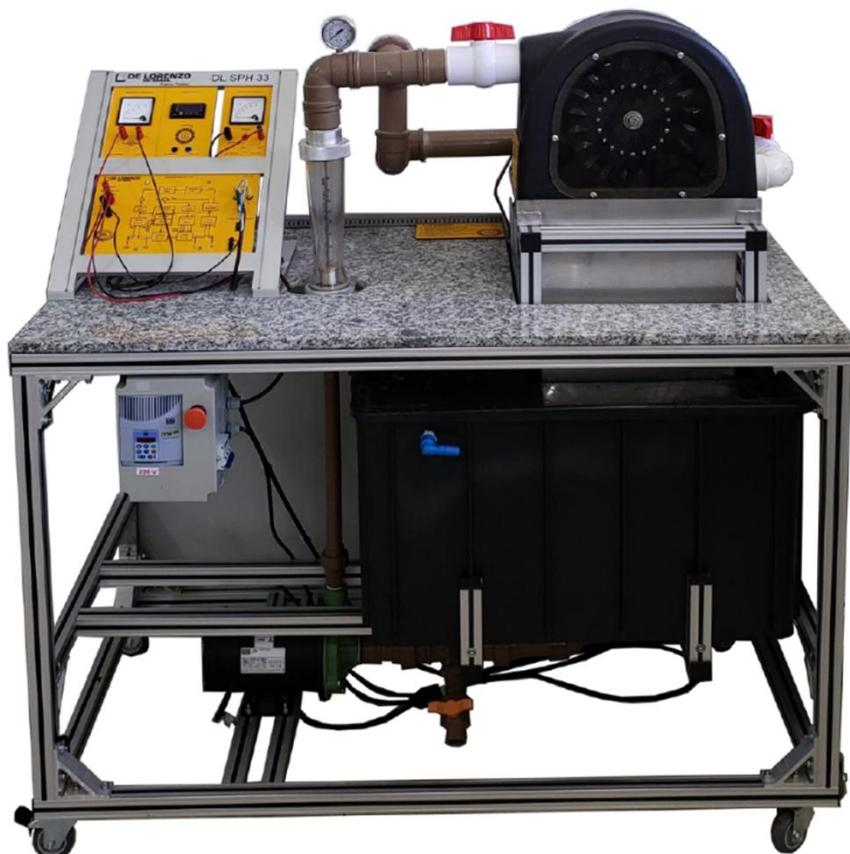
Un banco sviluppato per alimentare una turbina Pelton a doppio getto per convertire l'energia idraulica in energia elettrica e iniettare questa energia nella rete elettrica. L'apparecchiatura è progettata per studiare le funzioni e le misurazioni di un sistema di generazione idraulico/elettrico completo con una turbina reale che simula una tipica generazione idroelettrica.
