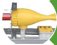
Un micro-réseau éolien alimenté par un servomoteur simulant l'action du vent.
