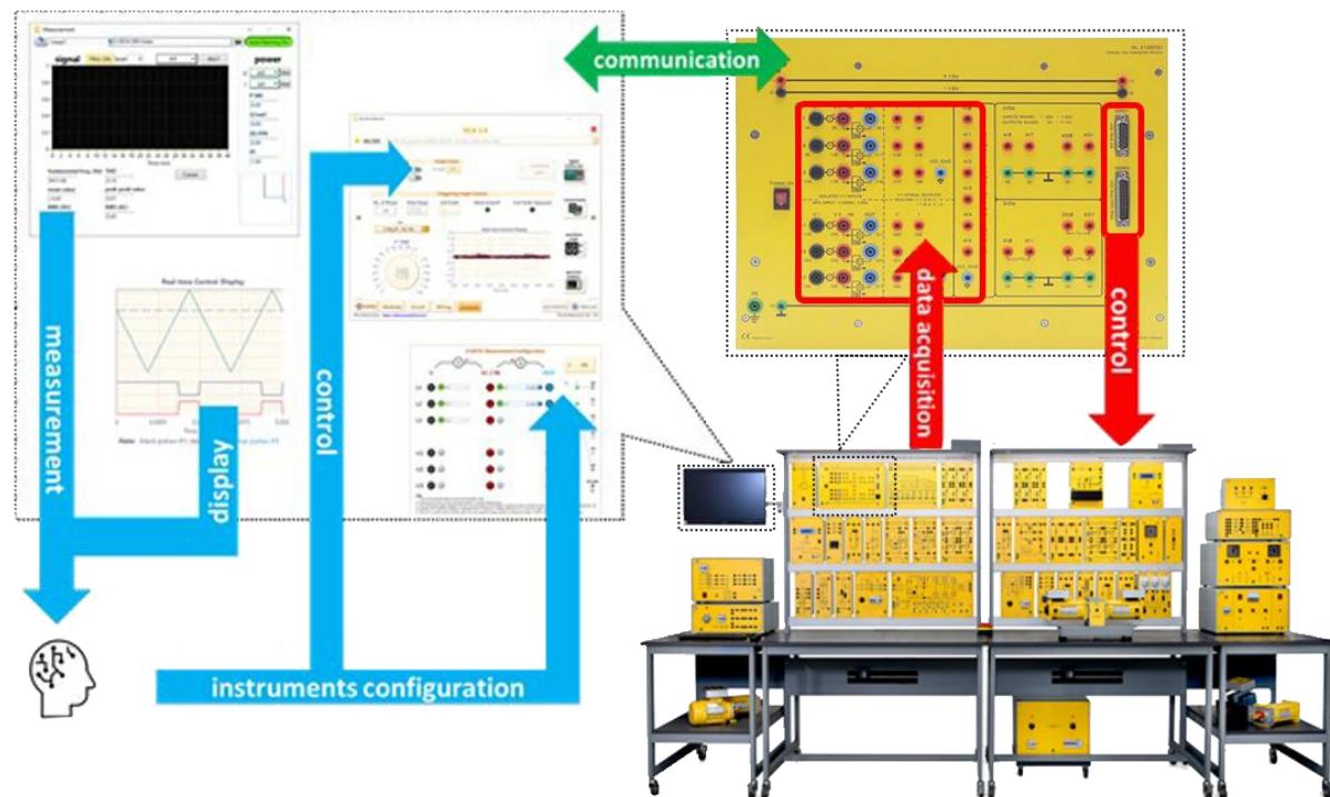
L'interfaccia software è programmata utilizzando LabVIEW, un linguaggio ampiamente utilizzato nell'industria e nelle università. L'interfaccia utente all-in-one fornisce una visione chiara dei segnali creati per controllare i dispositivi a semiconduttore e potenti strumenti matematici e di visualizzazione per osservare le forme d'onda risultanti e per studiare e simulare diversi controllori e strategie di conversione di potenza utilizzati nell'industria.
