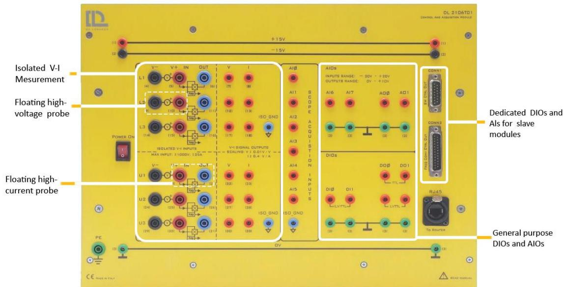
È possibile misurare contemporaneamente un massimo di 9 segnali di tensioni e correnti. I segnali collegati al pannello frontale sono ben isolati dal controllore ai fini dell'affidabilità e dell'anti-interferenza.
