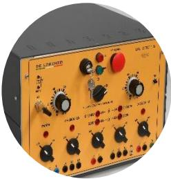
Un alimentatore trifase con uscite fisse e variabili in CA e CC che forniscono energia elettrica al banco di prova e alle macchine in studio. L'alimentatore include tutte le protezioni necessarie per creare un ambiente di lavoro sicuro per lo studente.
