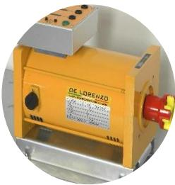
Un motore a corrente continua viene utilizzato come prime mover per lo studio dei generatori CA e CC e la sincronizzazione delle macchine con la rete elettrica.
