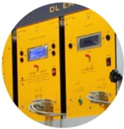
Moduli digitali multifunzione per la raccolta di tutti i parametri elettrici (tensione e corrente in CA e CC, valori RMS, potenza e frequenza attive, reattive e apparenti) e parametri meccanici (velocità, coppia) necessari per caratterizzare la macchina in studio.
