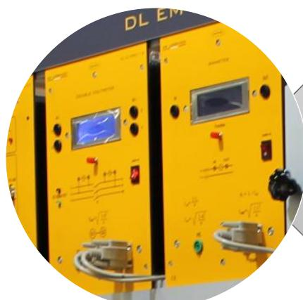
**Strumentazione:** essa acquisisce sia i dati meccanici (velocità, coppia e temperatura) che i dati elettrici (CA e CC, tensione, corrente e potenza).
