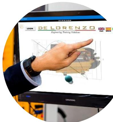
**Software di acquisizione dati per macchine elettriche:** esegue l'automazione del test e fornisce l'interfaccia utente per eseguire gli esperimenti. Il SW sviluppato in LabVIEW comunica con i dispositivi di acquisizione tramite porta seriale usando il protocollo Modbus, leggendo i dati elettrici e meccanici dagli strumenti.
