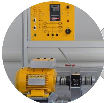
**Macchina di trascinamento:** Una macchina asincrona trifase a gabbia di scoiattolo controllata da un inverter a quattro quadranti che fornisce la potenza e la coppia meccanica necessarie per lo studio delle caratteristiche della macchina sotto esame.
