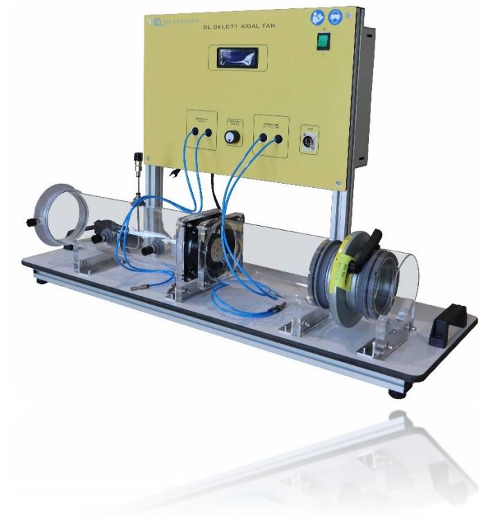
Questa apparecchiatura è stata progettata per lo studio delle caratteristiche di un ventilatore assiale che consente di eseguire un'ampia gamma di esercizi.
