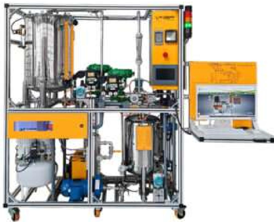
Questo impianto pilota di formazione teorica e pratica offre la possibilità di studiare il controllo in anello aperto e in anello chiuso dei quattro processi tipici utilizzati nell'industria: LIVELLO / PRESSIONE / TEMPERATURA / PORTATA.
