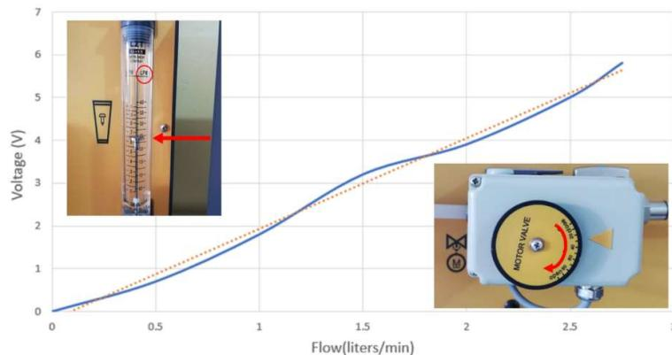
Durante estos experimentos, los alumnos aprenden a medir el caudal de agua utilizando la escala grabada del caudalímetro directo o el sensor de caudal de la turbina. Despues de analizar los resultados, deben poder implementar el ajuste del control PID del sistema con una estabilidad óptima.
