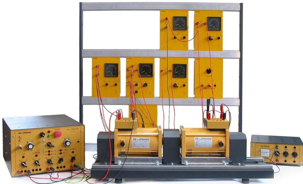
Questo sistema studia gli argomenti relativi alle misure elettriche con alternatore. Esso ha una struttura modulare che consiste in pannelli didattici installati nel telaio verticale.
